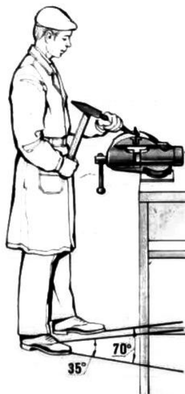
Рис. 2 – Положение ног при рубке металла
